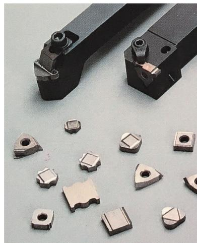
スローアウェイトツールは切削工具本体(ホルダー)の先端に装着する刃(チップ)の部分。摩耗や破損したらチップのみを交換する。さまざまな材質、形状のものが開発され、使い分けられている。
