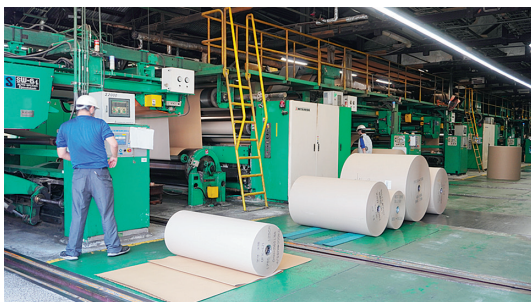
段ボールシートを製造するコルゲータは全長約 80m
