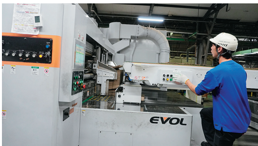
印刷、裁断、折り目付けを自動かつ高速に行える製箱機
