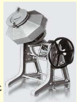
同時期に開発した可傾式 バルル研磨機
