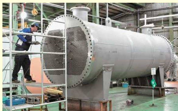
シェル&チューブ式の大型熱交換器
